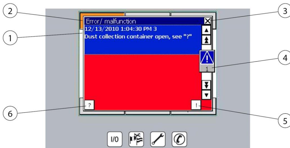
Rys. 99: Komunikat o usterce zbiorczego pojemnika na pył
