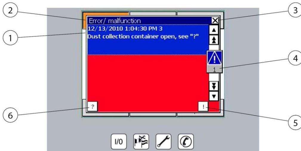
Abb. 40: Störungsmeldung Staubsaammelbehälter
